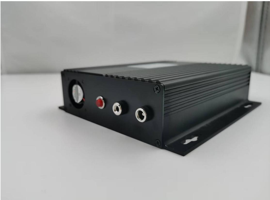
主控制器后挡板的部件，从左到右分别是：散热风扇、复位按钮，RS485 信号接口，5V 电源供电接口。
