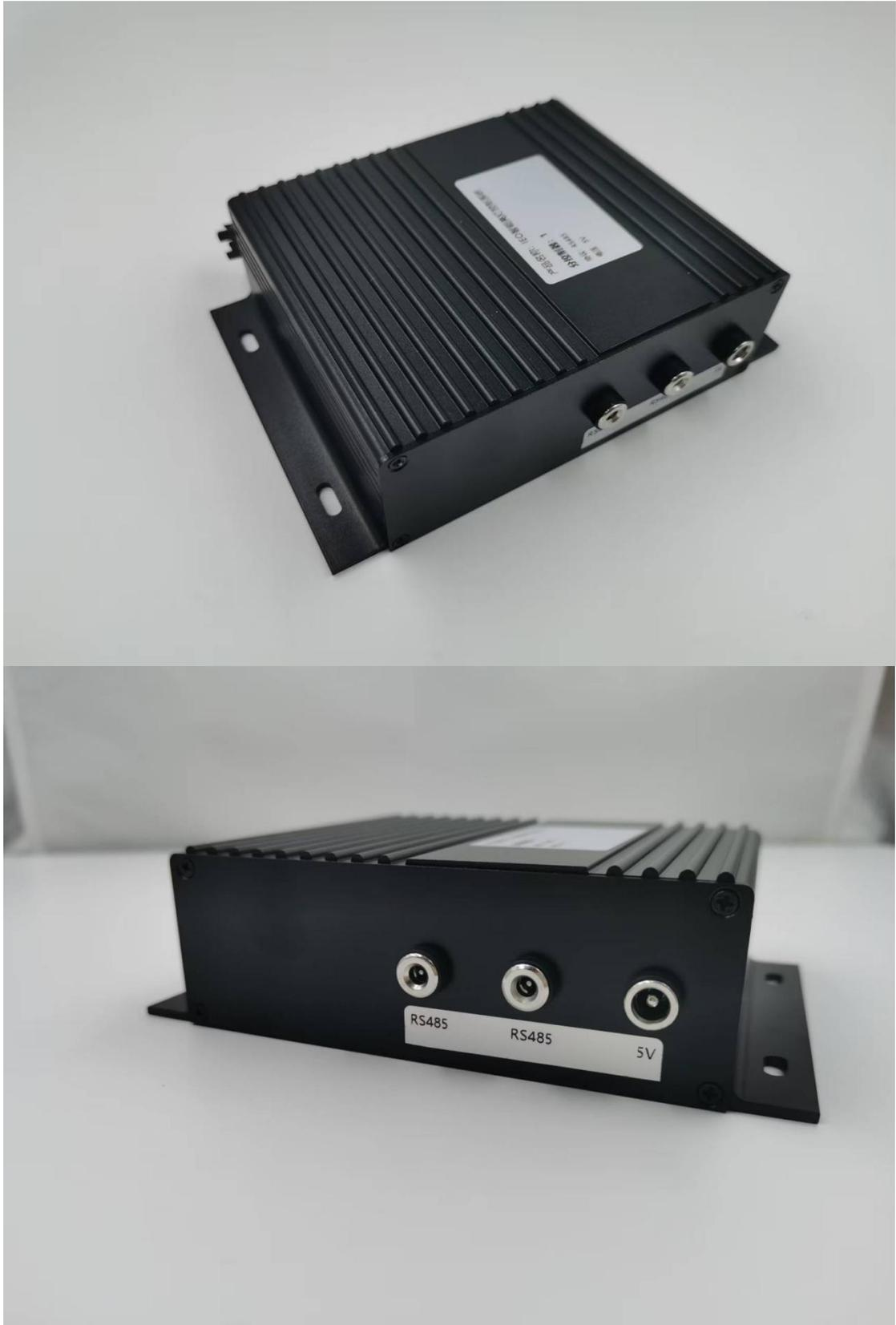
分控制器前挡板的部件，从左到右分别是：RS485 信号，RS485 信号接口，电源供电接口。
