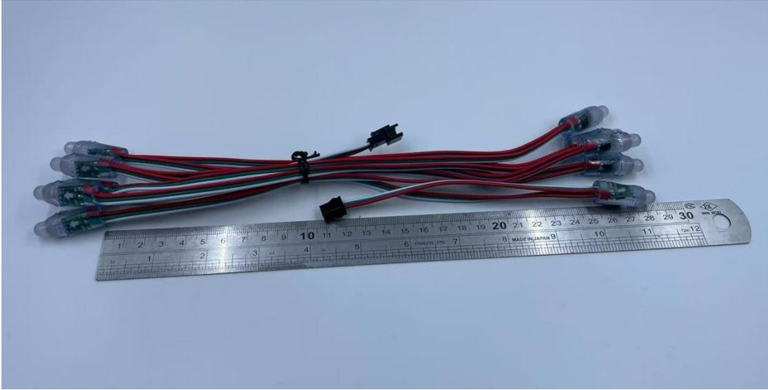
25CM 线长的 led 灯珠串，灯头直径 12mm。
